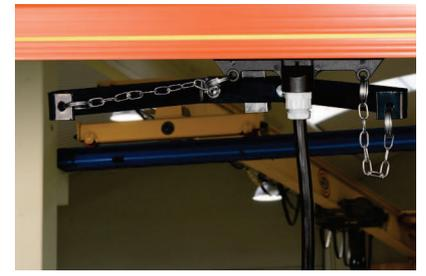
Montar el brazo de arrastre BA-4 en la estructura de la grúa o polipasto, alineando el tiro de la cadena con el eje central del perfil modular. El brazo de arrastre debe quedar entre 30mm y 50mm por debajo de dicho perfil.
