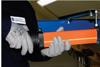
Fijar la cubierta de la tapa extrema TE-4 para evitar contactos eléctricos indeseados.
