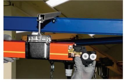
Introducir el carro tomacorriente, con presión manual de escobillas. Respetar la posición única para evitar intercambio de fases.
